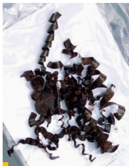
3 Náplň reakčnej bariéry – odpadové Fe špony – po 4 mesiacoch fungovania pasívneho čistiacieho systému
