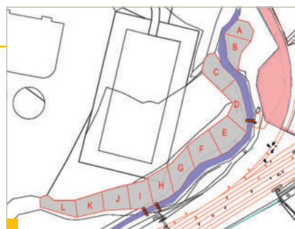
19 Rozloženie jednotlivých segmentov a umiestnenie dočasných hrádzok
