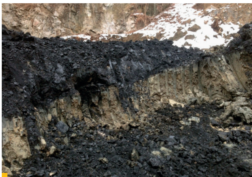
5 Vrstva tesniaceho ílu vmiešaná medzi dve gudrónové vrstvy
