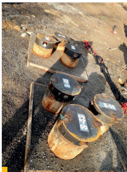
31 | 32 Zabudované reakčné brány a osádzanie reakčných košov
