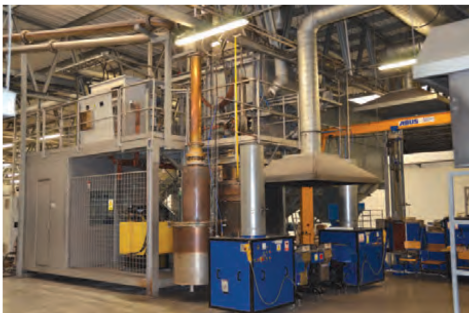
Obr. 2 Plazmové zariadenie na spracovanie elektroodpadu v Poľsku
