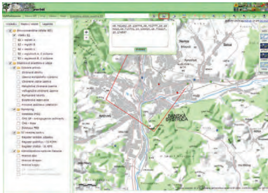
Obr. 4 Zobrazenie grafického prvku typu „čiara“, ktorý je definovaný súradnicami WGS 84
