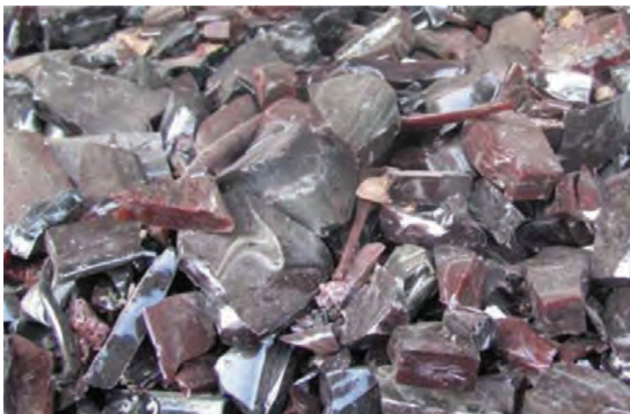
Obr. 3 Tuhý produkt splyňovania – troska alebo vitrifikát
