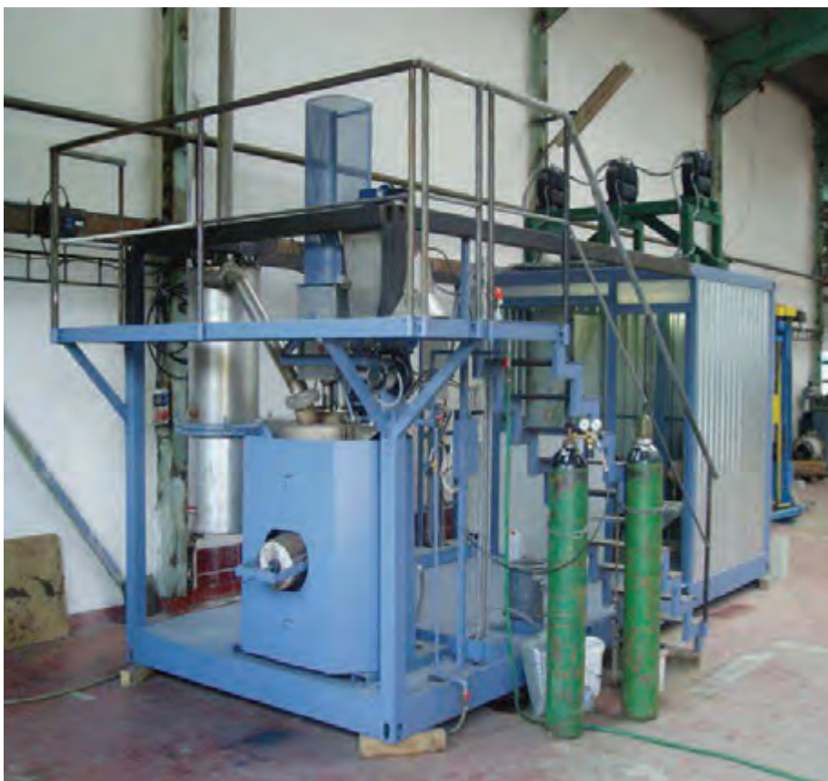
Obr. 4 Plazmové zariadenie na testovanie vzoriek odpadu
